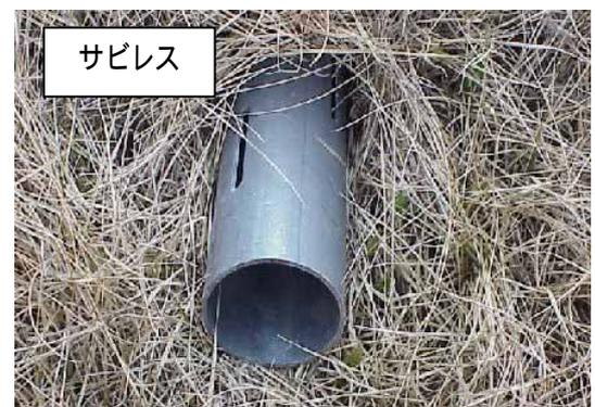
このパイプに用いられている、高耐食溶融メッキ(ZAM)は、亜鉛(Zinc)-アルミニウム(Aluminum)-マグネシウム(Magnesium)からなり、同じ塗布量ならば、通常の溶融亜鉛メッキの10倍以上の耐食性を示します。これは、ZAMに含まれるMgとAlの効果により、時間の経過とともに緻密で付着性の強い二層構造の保護皮膜をメッキ表面に形成し、メッキ自身の腐蝕も抑制するため、優れた耐食性を発揮することができるというものです。
