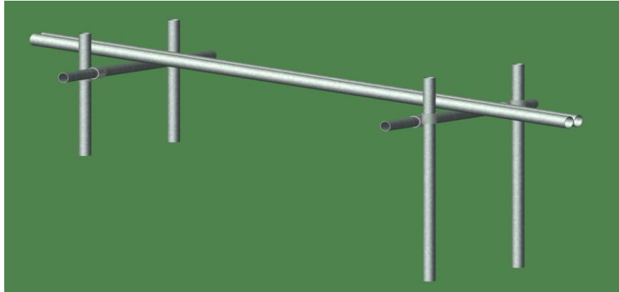
図-3 単管架台設置状況
