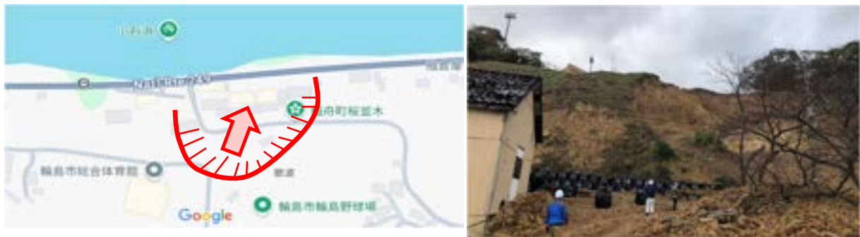
図 3.1.17 輪島市総合体育館・野球場の盛土地盤・斜面崩壊が豪雨により被害拡大した様子
