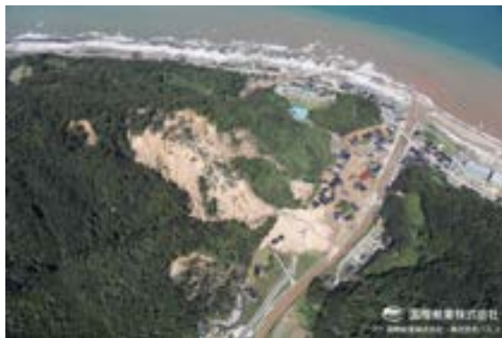
左図 5.2.3-2 航空写真による大谷町地区の 9 月豪雨後の土砂流出状況（2024 年 9 月 23 日撮影） 5)
