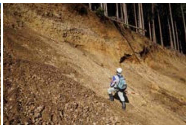
図 5.1.2 崩壊の滑落崖の高さは約 2m
