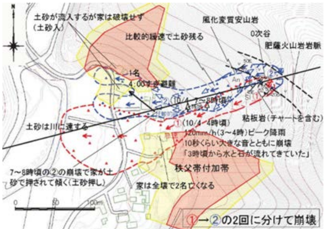
図 4.2.6 2020 年九州南部豪雨で土砂災害防止法外の土砂災害 6) (地理院地図利用)
