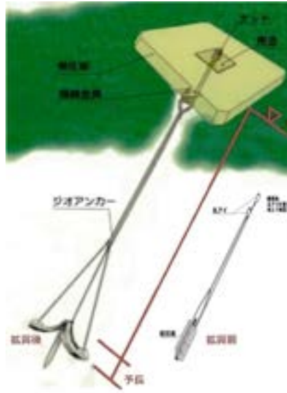
図 3. 2. 13 拡翼型盛土補強工法（ジオアンカー工法） 7)
