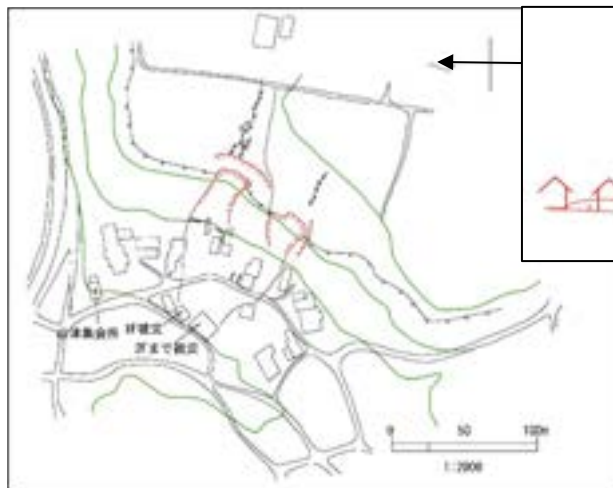
図 5.1.4 段丘の縁で発生した 2 箇所の崩壊
