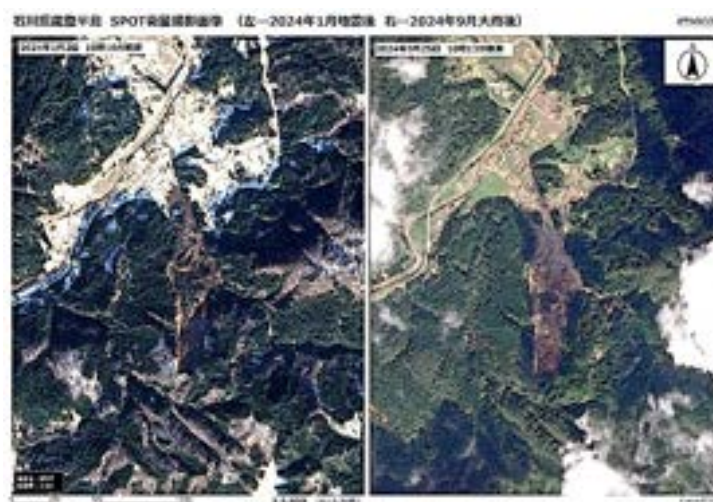
図 5. 2. 3-27 輪島市市ノ瀬地すべり 1 月地震直後(左)と 9 月豪雨直後(右)の土砂災害状況 7)
