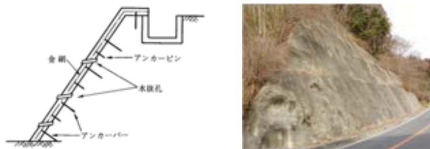
図 3.3.7 吹付工の概要 1)
