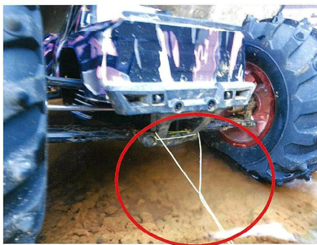
写真-2 車体の後部に取り付けられたPE製釣り糸
