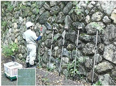
図-5 擁壁の表面波探査状況
