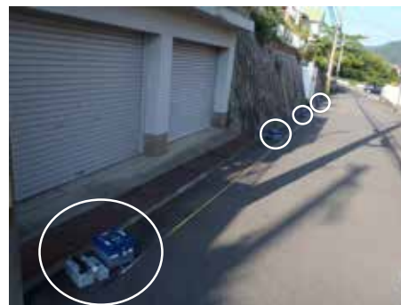
図-3 微動アレイ探査の測定状況 (丸印が受振器)
