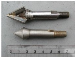
先端コーン 上が羽根付き コーン (ベ ンコーン) 下が通常 のコーン (円錐 コーン)
