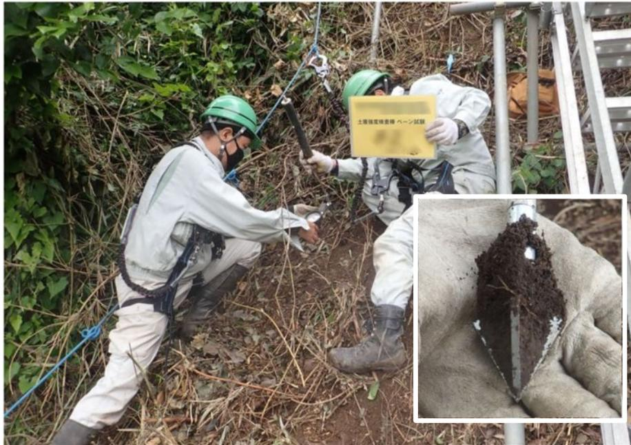
土層強度検査棒（Soil Strength Probe）
