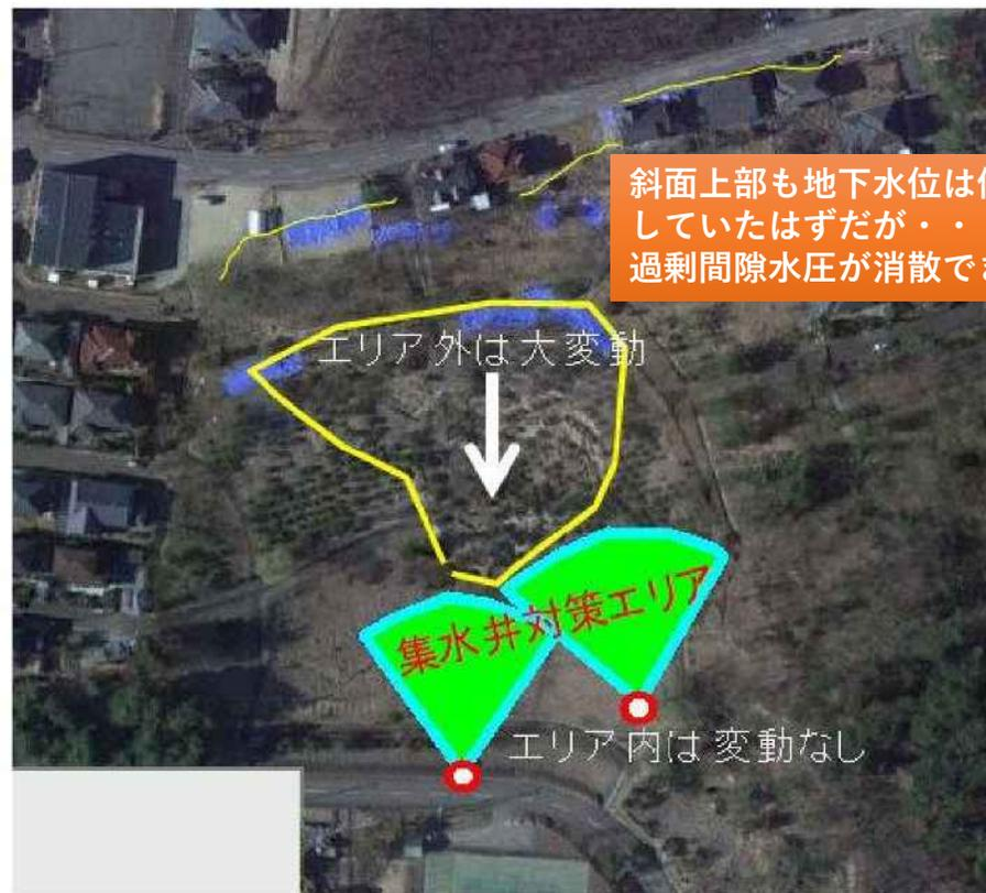
写真5 集水ボーリング到達域は変動せず
