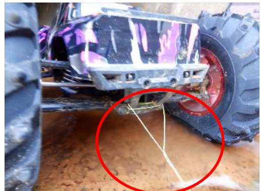
図-3 車体の後部に PE 製釣り糸を括り付けた改良型 RC 車
