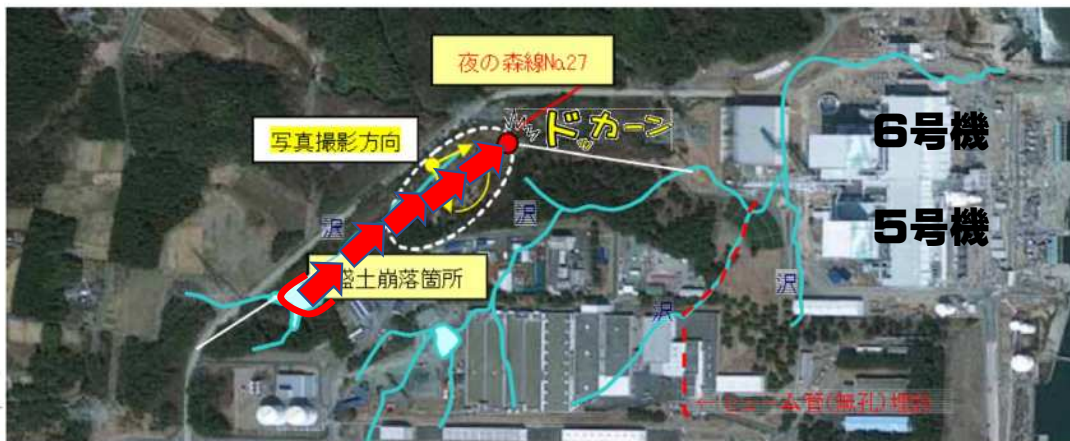
図4：盛土の崩壊状況写真（震災後に撮影；造成前の沢を重ね書き）
