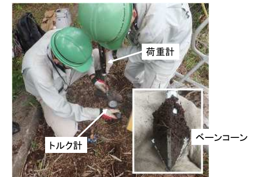
ベーンコーンせん断強度試験 (上載荷重を変化させ c, \phi 強度計測)
