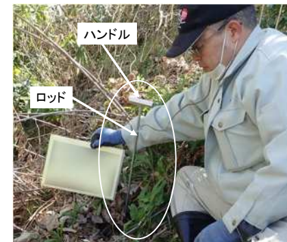
限界貫入深度試験 (ロッドが人力で挿入できる限界深度計測)
