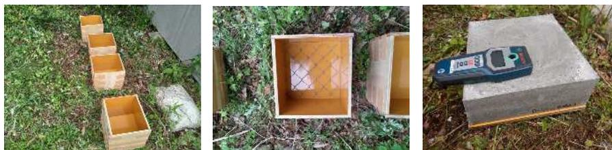
ラス金網を埋設したモルタルとラス金網が無いモルタル模型を作製し、金属探知機でラス金網の有無が探知できるか実験した結果、深度15cmまでは、ラス金網の有無が**数秒**で確実に判定できることが分かった。
