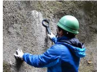
金属探査機による吹付モルタル内のラス金網探査状況
