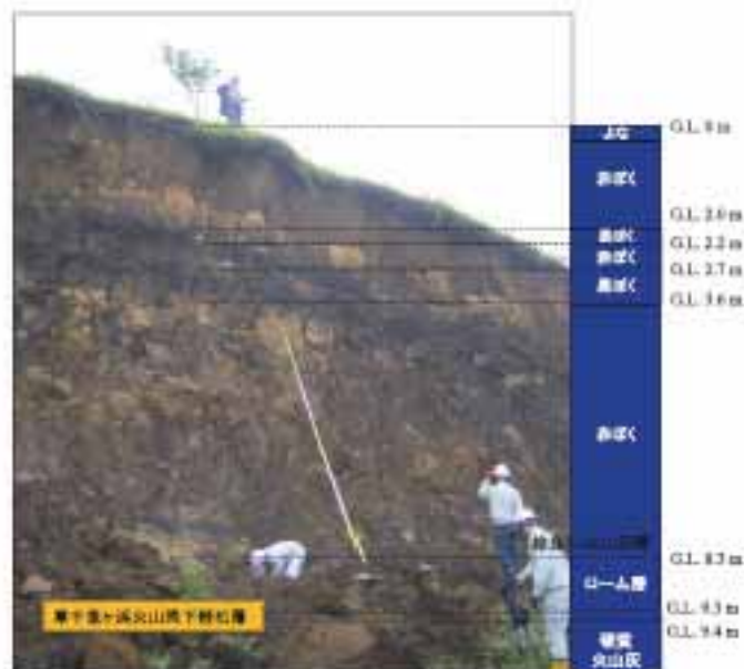
図 2.3-2 滑落崖の土層構成 5)
