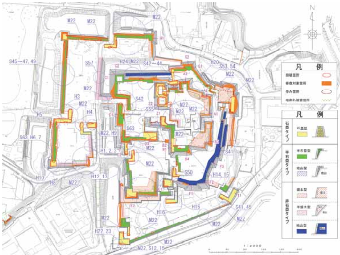
図 8.1-42 熊本城石垣の修復履歴と被害状況の整理・分析
