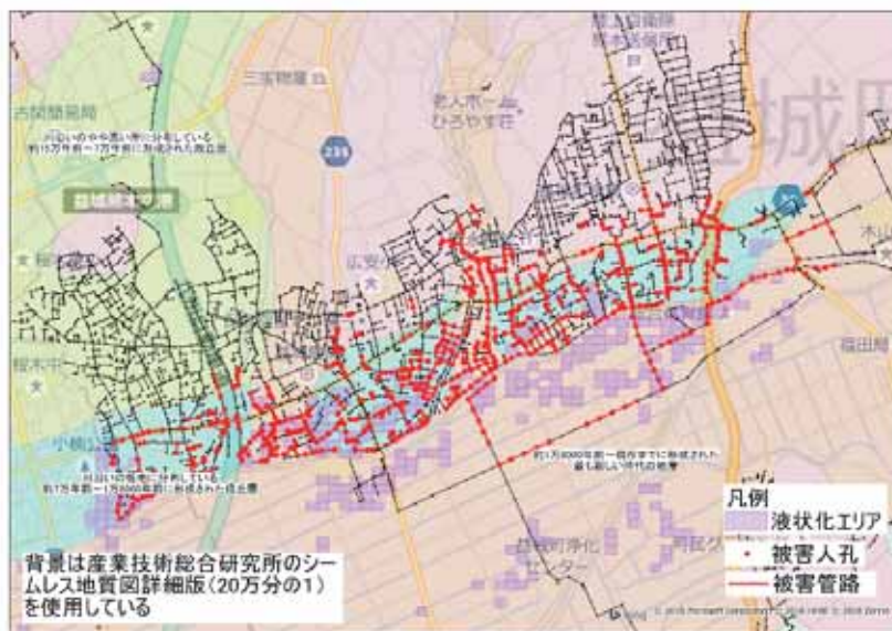
図 6.2-7 益城町の下水道管路施設被害位置とその地盤特性 （液状化エリアは文献 6 を参照）
