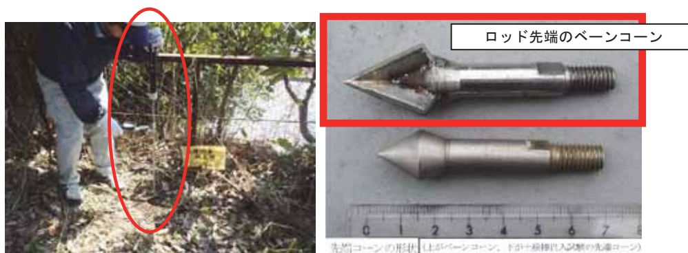
図 2.8-22 ベーンコーンせん断試験の計測状況（左写真）及びロッド先端のベーンコーンの形状（右写真）
