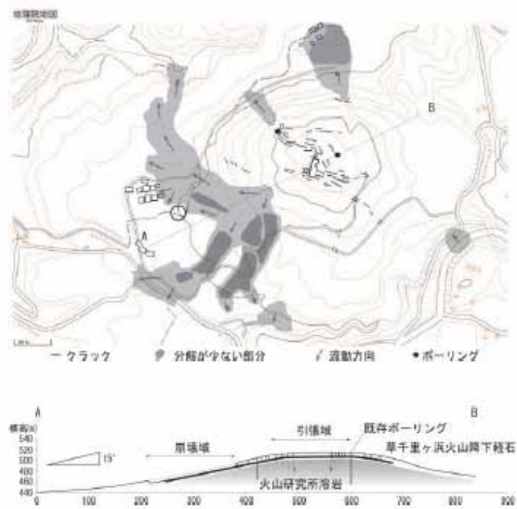
図 2.3-1 地すべりの平面図と地質断面図 (釜井, 2017) 7)
