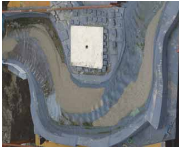
写真真 7.3-6 土砂の堆積状況 (CaseMS-2)
