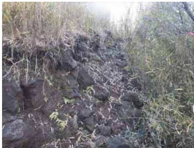
図 2.8-20 No.1 の表層土砂の土質（砂混り岩塊）
