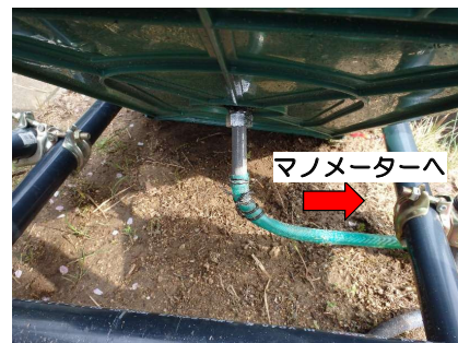
図-2 パイプ流を表現したホースから水が噴き出す仕組み
