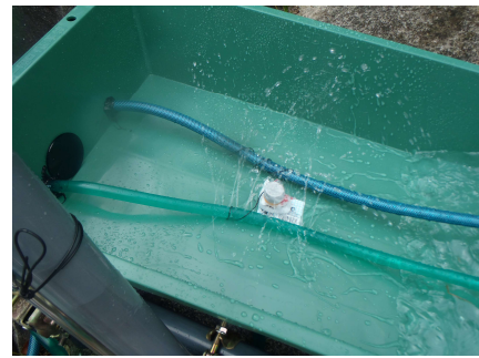
図-2 パイプ流を表現したホースから水が噴き出す仕組み
