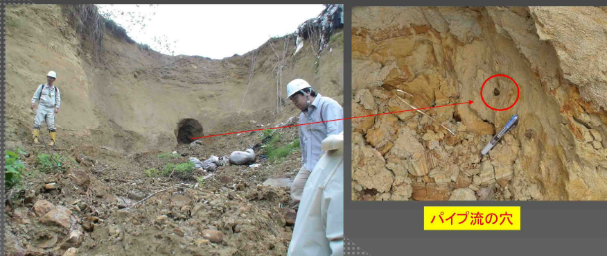
中越地震で崩壊した斜面 パイプ流の被圧水圧で爆裂した巨大な穴
