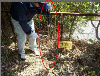
土層強度検査棒による c, \phi 測定状況
