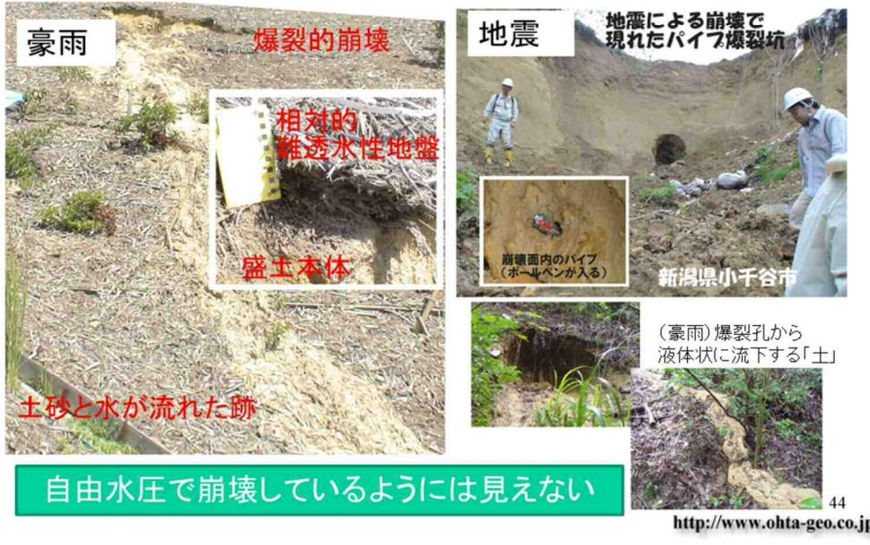
見るからに高い水圧が土中にかかり、表層部の相対的な難透水層を突き破って、崩壊が発生している例が多くあります。これらが、被圧水の仕業である可能性が高いということをあぶり出すには、少なくとも現地盤の $c \cdot \phi$ は実計測値である必要がありました。地震時の場合には、被圧水と言うよりも「過剰間隙水圧」かもしれません。過剰間隙水圧の最大値は自重分ですが、被圧水は斜面上方から作用する可能性があるため、むしろ豪雨時の被圧水の方が地震時の過剰間隙水圧よりも多気かも知れません。
