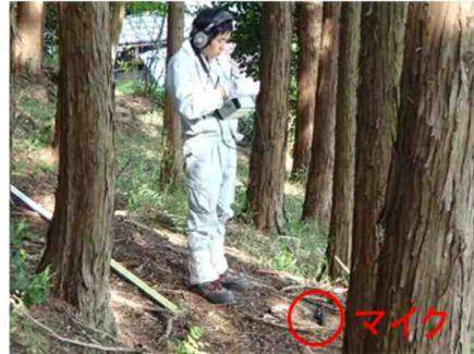
湧水箇所の近くで地中音のパワーレベルが大きくなる
