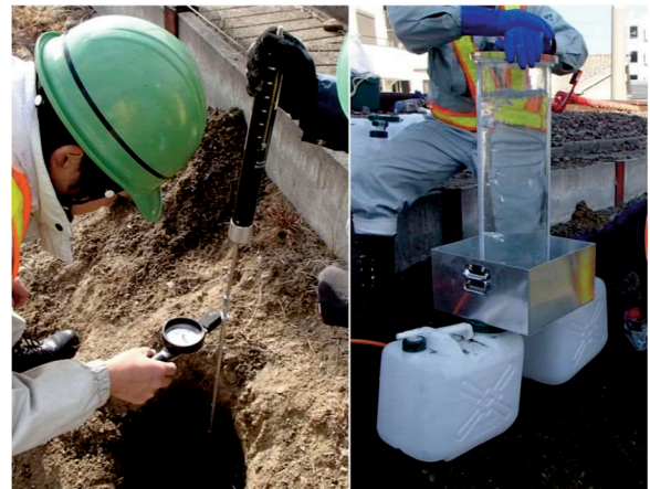
図-1 土層強度検査棒試験(左)と浅層型原位置透水試験(右)の実施状況
