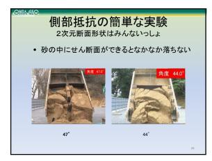
2次元解析をすれば、すべて同じ形状の断面になるが、抵抗力はまるで違う 動画だが、pdfなので動かない
