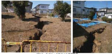
図3.3 北ブロック地すべり調査結果 (1978年宮城総沖地震でも、ほぼ同様の位置に亀裂の発生・露り取り調査による)
