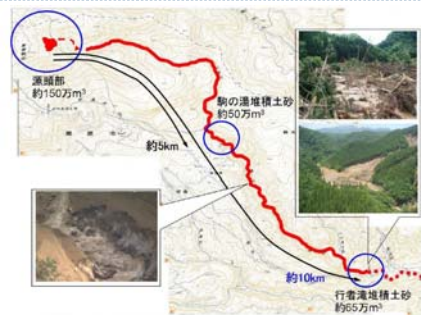
図-443 長い距離を駆け下る土石流の流下経路と堆積堆積土砂量 (施設技術コンサルタントによる。堆積は国土利用計画が国土を利用)
