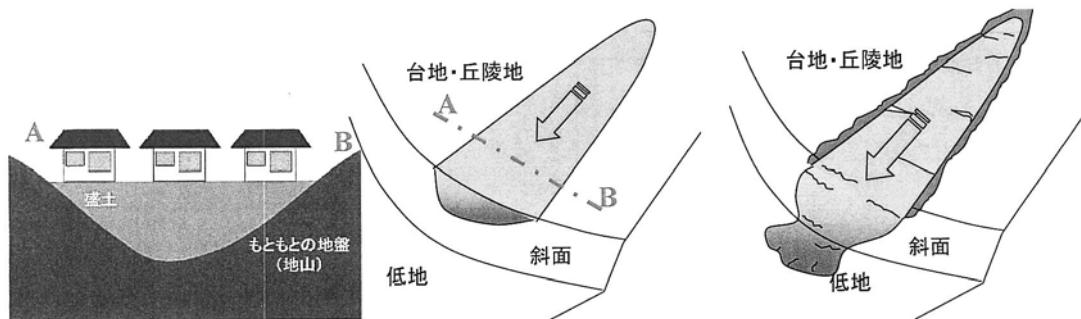
図-1. 谷埋め盛土の「滑動崩落」概念図<sup>1)</sup>
