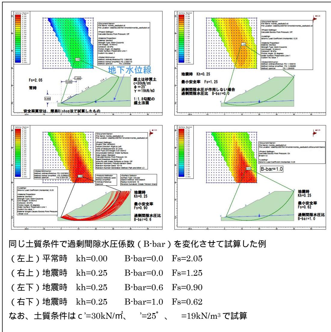
同じ土質条件で過剰間隙水圧係数( $B$ -bar)を変化させて試算した例
