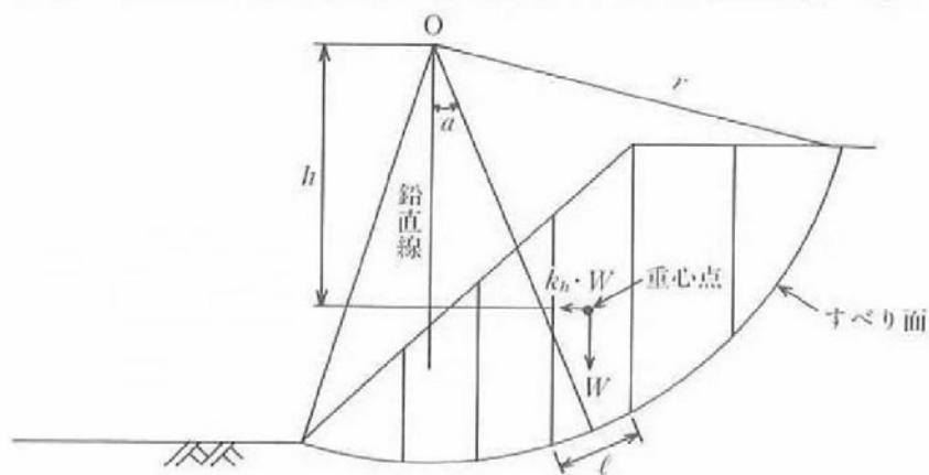
図V.2.2 円弧すべり面法における各分割片に働く力（地震時）
