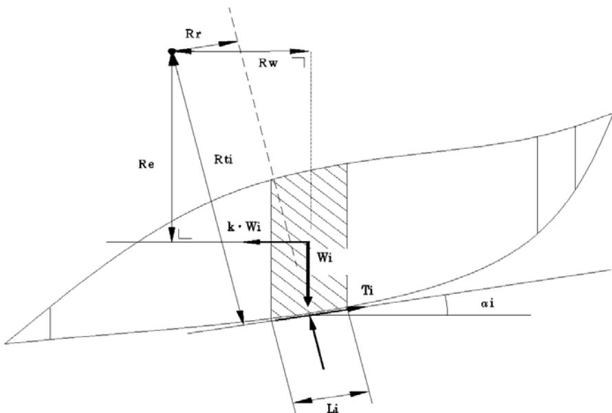
図V.2.1 二次元の分割法における各分割片に働く力（地震時）
