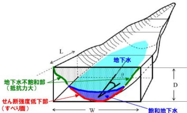
$L_0$  : 単位長さ,  $L$  : 全体長,  $W$  : 幅,  $D$  : 厚さ,  $\theta$  : 斜面の傾斜角
