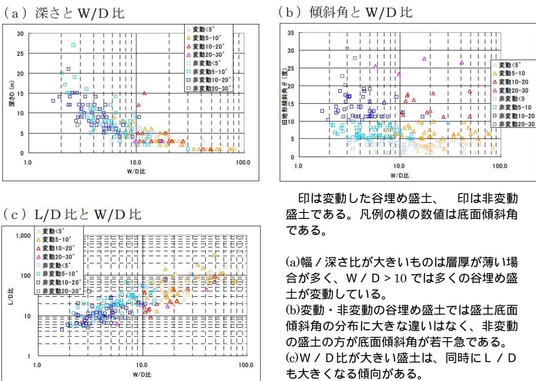
印は変動した谷埋め盛土、印は非変動盛土である。凡例の横の数値は底面傾斜角である。
