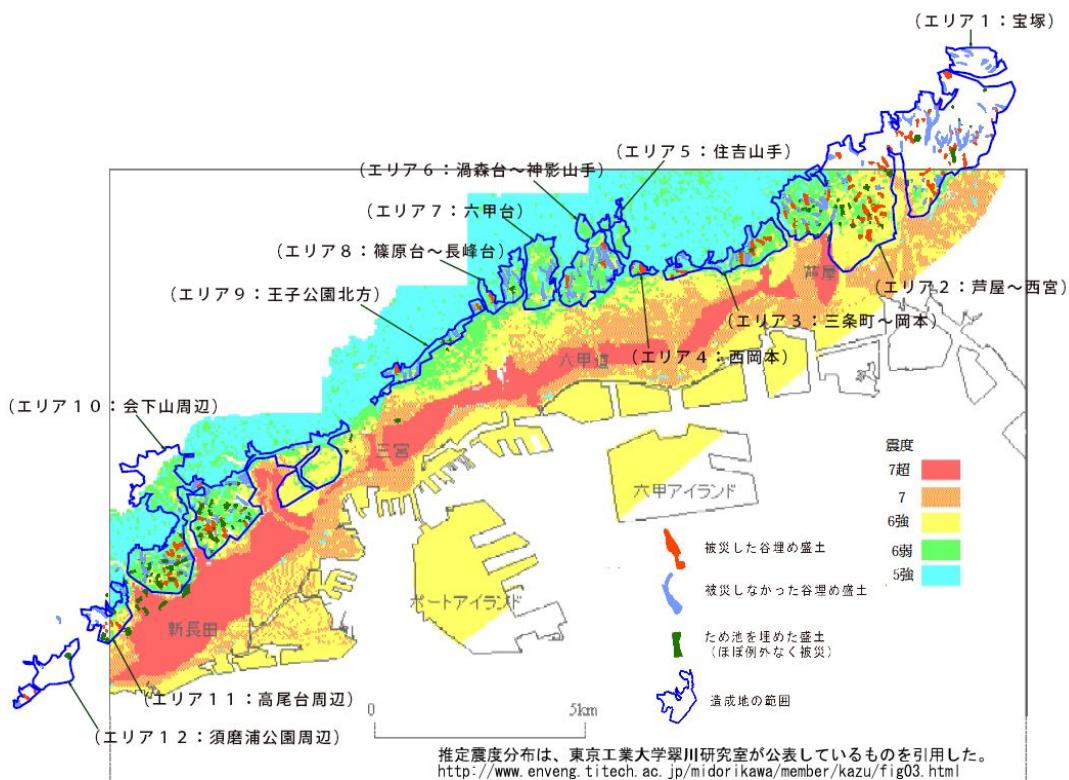
図-3 震度分布図と造成地内の盛土分布の重ね合わせ図
