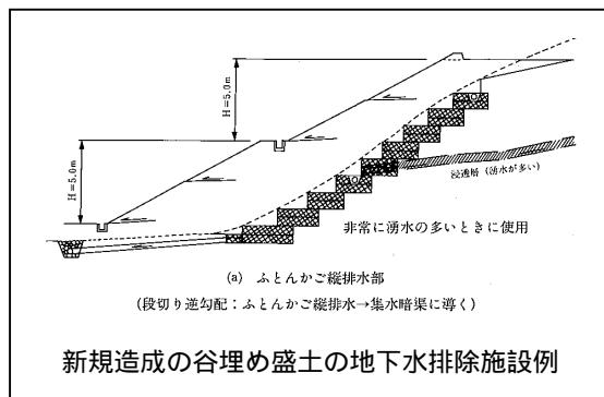
新規造成の谷埋め盛土の場合には、手厚い地下水排除施設の設置が望ましい(右図参照)しかし地形条件等によって、重力排水が困難な箇所も存在すると考えられるので、人工的な構造物による抑止工が必要となる場合も多々あると考えられる。
