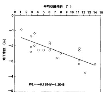
図-7 谷埋め盛土中の地下水位と盛土底面の平均傾斜角の関係<sup>2)</sup>
