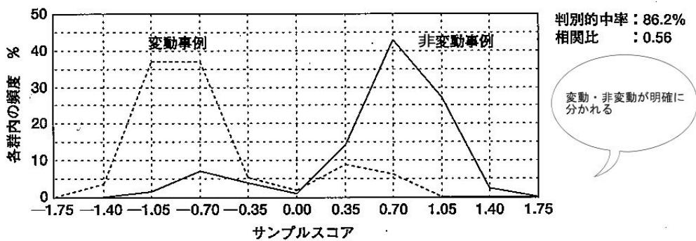
図-5 予測モデル（数量化類）における谷埋め盛土変動要因の分析結果<sup>2)</sup>
