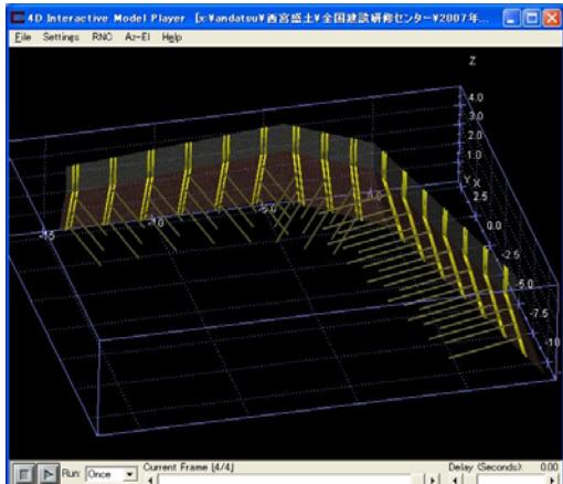
地盤内の排水および補強構造
