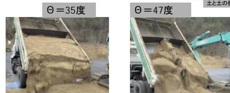
3方を鉄板で囲まれた乾燥砂での実験
