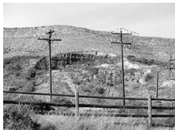
図-7 Basalt lavaからの湧水により発生した崩壊
