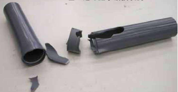
V P 40 差し込み継手破損状況
