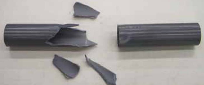
V P 50 ネジ継手破損状況
