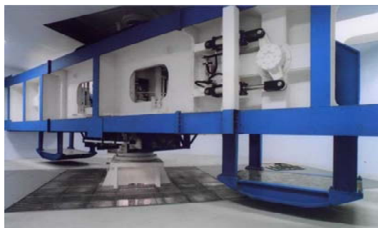
図5 実験装置(遠心力载荷試験装置)
